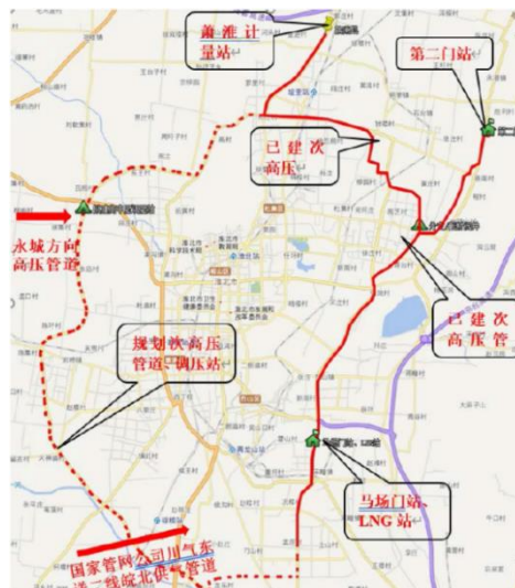
图 2-19 淮北市现状高压天然气管网布局图
